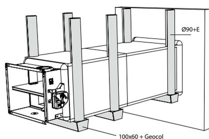
7. Les tiges filetées sont protégées par ½ coquilles en staff Ø 90 mm et maintenues entre elles par colle et polochonnage. La traverse est protégée par un profilé en « U » de protection en GEOFLAM 100 x 60 mm, collé à la sous-face du gaine par du plâtre pour collage de type GEOCOL (GEOSTAFF).
