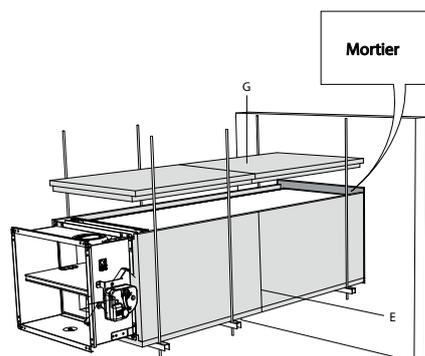
5. La réservation autour de la gaine dans la paroi est remplie par du mortier standard. La gaine traversante est recouverte de plaques de staff de référence GEOFLAM F d'épaisseur 45 mm ou GEOFLAM Light d'épaisseur 35 mm « G ». Les plaques sont fixées entre elles autour de la gaine par colle et polochonnage « E ». Le corps du clapet est également ainsi protégé sur une longueur de 120 mm.
