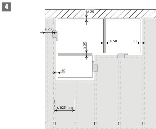
4. Les clapets peuvent être installés à distance minimale d'une dalle/d'un plafond ( $\geq 25 \text{ mm}$ ), d'une paroi ou d'un autre clapet ( $\geq 50 \text{ mm}$ ).
