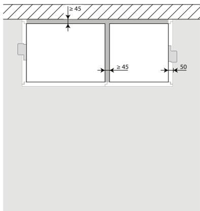
9. Les clapets peuvent être installés à distance minimale d'une dalle/d'un plafond ( $\geq 25$  mm), d'une paroi ou d'un autre clapet ( $\geq 50$  mm).
