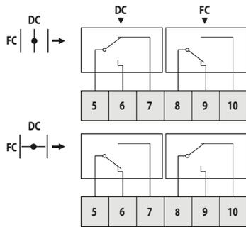
DC : Contact position ouverte du clapet
