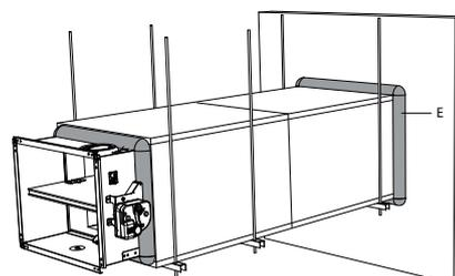
6. La protection en staff GEOFLAM F s'arrête à 15 mm du mur. L'espace libre entre le mur et la protection en staff est comblé par bourrage de polochons (mélange de plâtre et de filasse). Ce bourrage est également appliqué sur la jonction entre la gaine et le tunnel du clapet.
