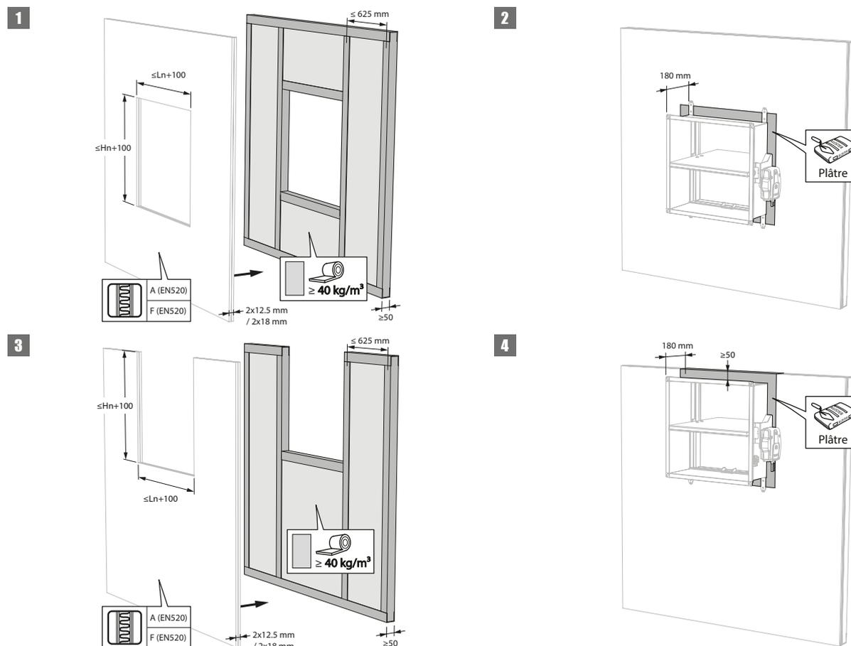
3. Les clapets peuvent être installés à distance minimale ( $\geq 50 \text{ mm}$ ) d'un plafond ou d'une dalle.
