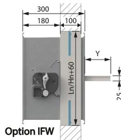
Dépassement transmission et mécanisme si  $H_n \leq 150$  mm
