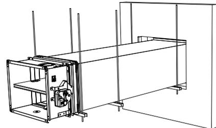
3. Une réservation de dimensions maximales « A » est réalisée au travers de la paroi.
