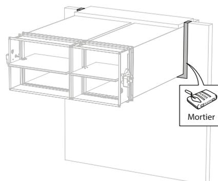
11. Colmatez la réservation du côté des distances minimales à l'aide de panneaux rigides de laine de roche ( $\geq 150$  kg/m<sup>3</sup>) sur une profondeur de 400 mm (150 mm du côté mécanique de la paroi).
