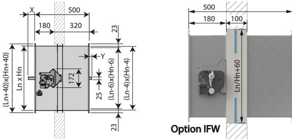
Dépassement transmission et mécanisme si  $H_n \leq 150$  mm
